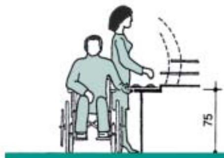
Dimensiones básicas de una barra de autoservicio
